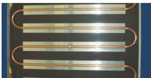
> Die Kühleinlage < Mäanderförmig gebogene Kühlelemente aus Kupferrohr  $\varnothing$  10,0/12,0 x 0,6 mm werden mit Wärmeleitprofilen aus Aluminium verpresst und mit den Deckenplatten ultrahomogen verbunden. Die Enden der Kupferrohre sind kalibriert und mit Schutzkappen versehen, d.h. für den problemlosen Anschluss von Flex-Schläuchen mit Steck-Fittings vorbereitet.
